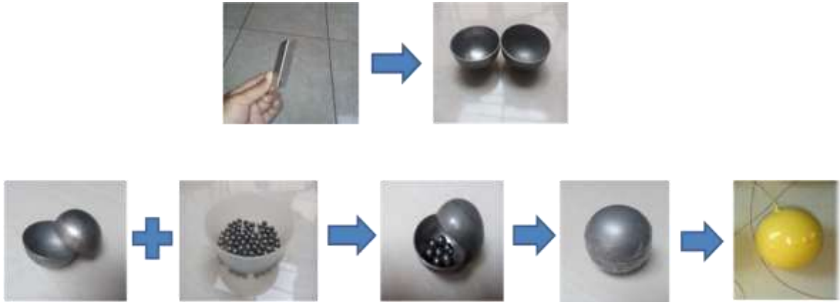
Gambar 1. Proses pembuatan bola baja berongga untuk eksperimen hukum Archimedes
