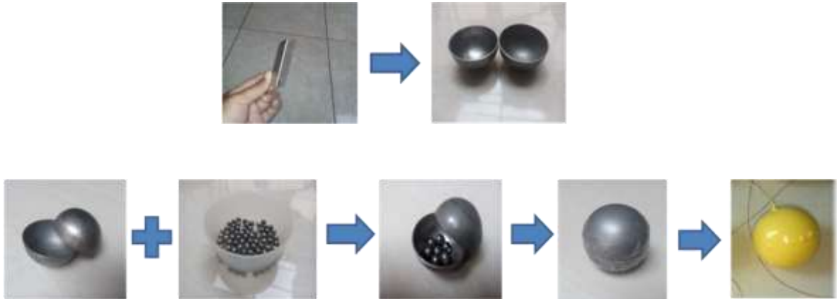
Gambar 1. Proses pembuatan bola baja berongga untuk eksperimen hukum Archimedes
