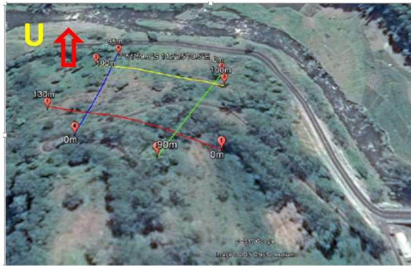
Gambar 4. Lintasan Pengukuran pada Lokasi Penelitian
